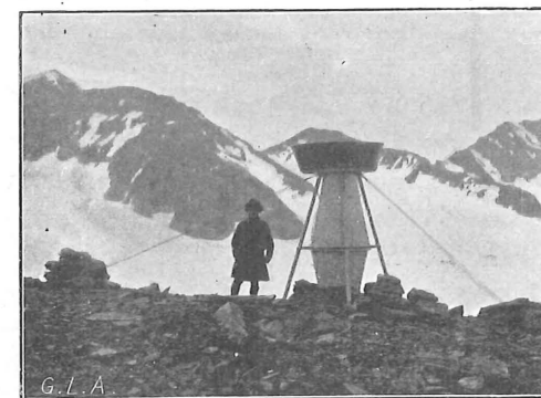
Fig. 25. Nederbördsjätmätare vid Luleavaggeglacieren på 1 530 m. ö. h.
