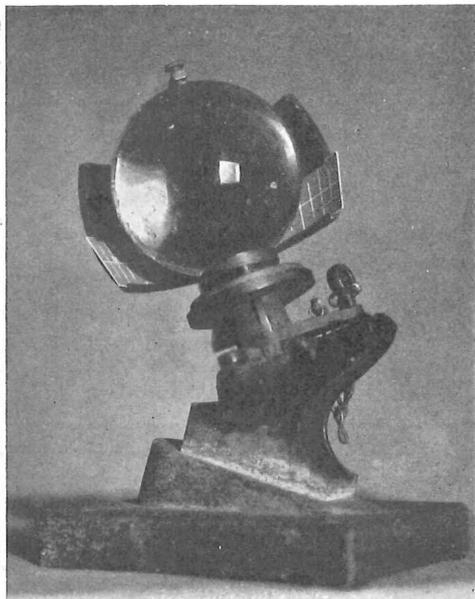
Fig. 28. Der Sonnenscheinautograph mit der Kugelschale zur Aufnahme des Sonnenscheins 12—8p orientiert. Verf. phot.
