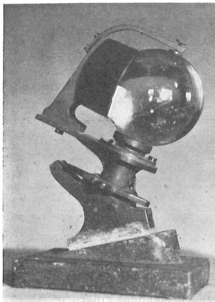
Fig. 27. Der Sonnenscheinautograph mit der Kugelschale zur Aufnahme der Mitternachtssonne orientiert.
